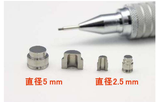
図 2 圧力センサー用金属ガラス起歪体 (ダイヤフラム)。
